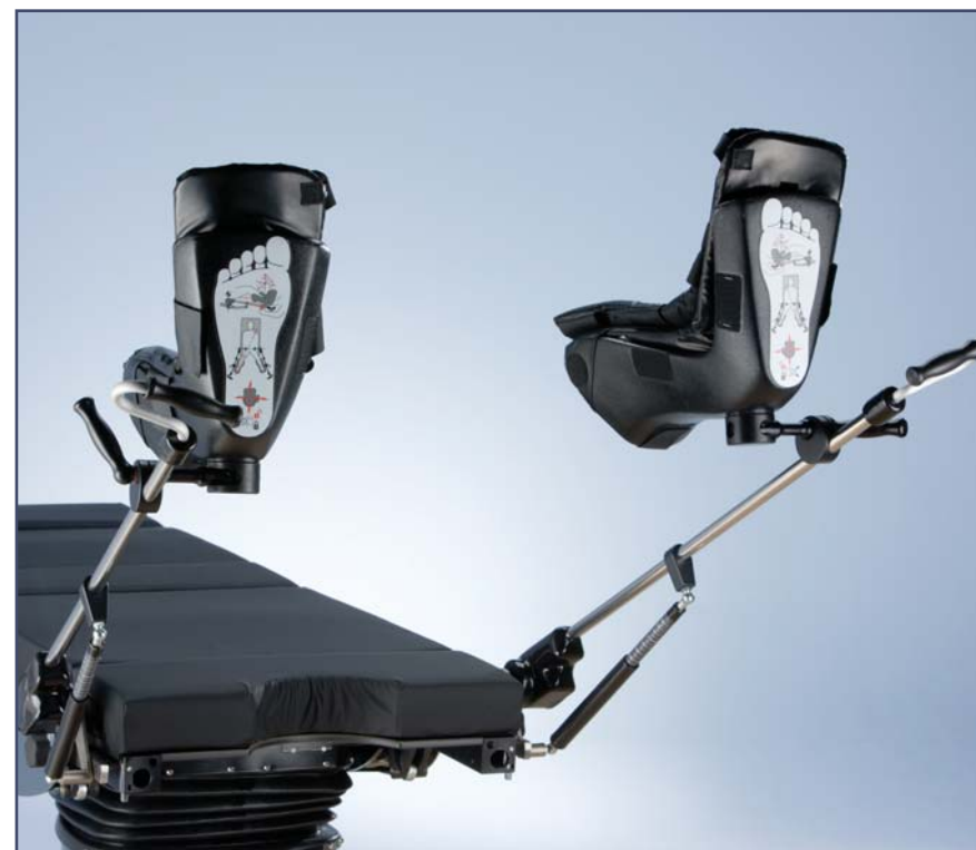
3D jalkatuett, joiden ainutlaatuinen kaasujousirakenne mahdollistaa jalan liikuttamisen kevyesti ja tarkasti. Puristuskahva mahdollistaa litotomian ja loitontamisen steriilillä alueella. Lämpömuovautuvat comfort-pehmusteet. SWL 160kg. Koodi 60320. Vaatii kiskolukot 60200.
